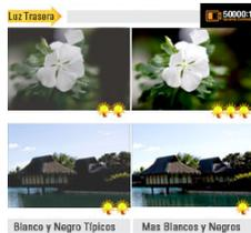
¿Cómo hemos podido llegar a conseguir un contraste dinámico de 50,000:1? La iluminación y la gamma de cada fotograma se ajustan al monitor por lo que obtenemos un contraste optimizado entre fotogramas. Las imágenes brillantes reciben una alta retroiluminación con control de gamma. Las imágenes oscuras reciben menor retroiluminación con control de gamma.
